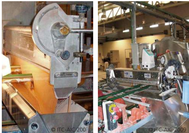
Figura 10 a y b. Equipo de aplicación de esmalte a cortina mediante presión.
